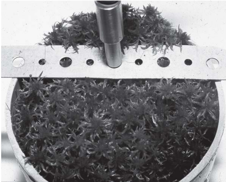
Abb. 1: Messanordnung zur Bestimmung der optimalen Quantenausbeute.
